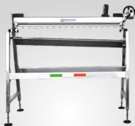
IT Silver Genius, preparatore automatico smalto e controllo densità EN Silver Genius, glaze automatic preparation and density control ES Silver Genius, preparacion automatica esmaltes y control densidad
