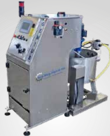
IT Silver Genius, preparatore automatico smalto e controllo densità EN Silver Genius, glaze automatic preparation and density control ES Silver Genius, preparacion automatica esmaltes y control densidad
